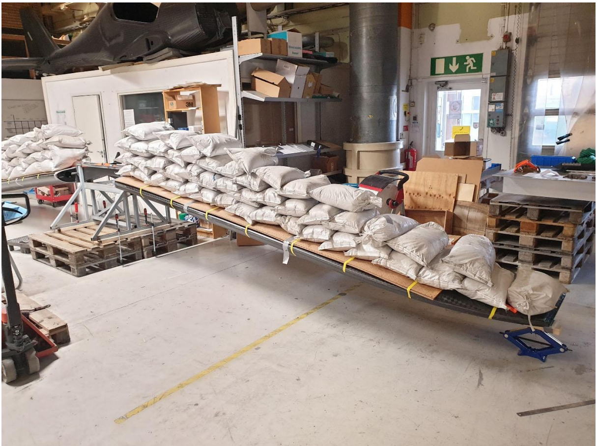
Bild 2. Belastningstest av GreenWing. Sandsäckar med en vikt av 1855 kg lastades på båda vinghalvorna.
